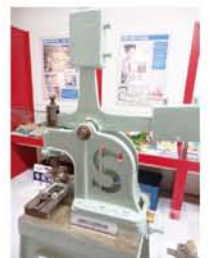
足踏み式単打ち石鹼成形機。大量生産体制が確立されるまでは、手作業で石鹼を一つずつ枠にはめ、ロゴを刻印していました。
