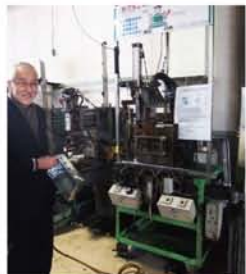
たこ焼き用ロボットは、プレス機で加工し、空気穴を開けた後、鉄板をマシン中央のガイド(四角部分)に沿って折り曲げ、溶接します。たこ焼きの生地を流すプレートの部分は錆物やさんに外注しているそうです。
